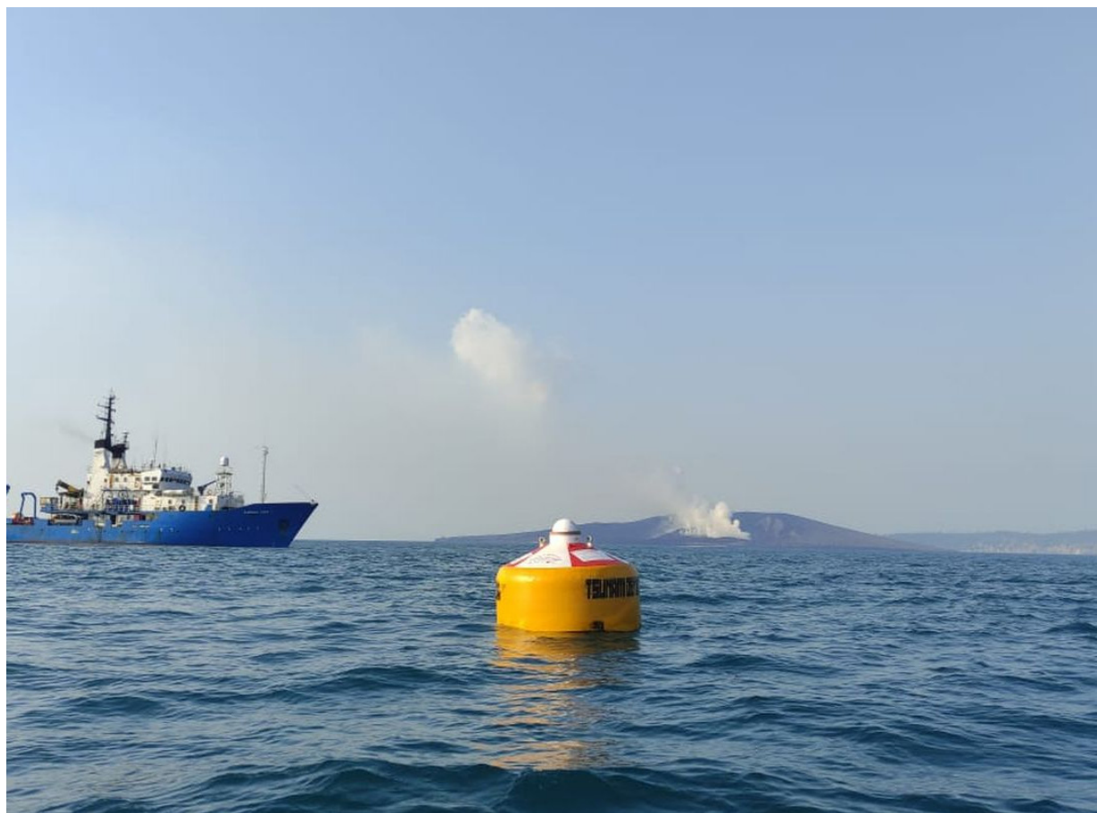
Contoh InaTews Buoy hasil rakitan Badan Pengkajian dan Penerapan Teknologi (BPPT) yang beroperasi di Perairan Gunung Anak Krakatau (Humas BPPT via Kompas, 2021).
